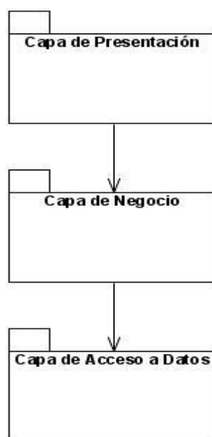
Figura 21 Arquitectura en 3 capas.
