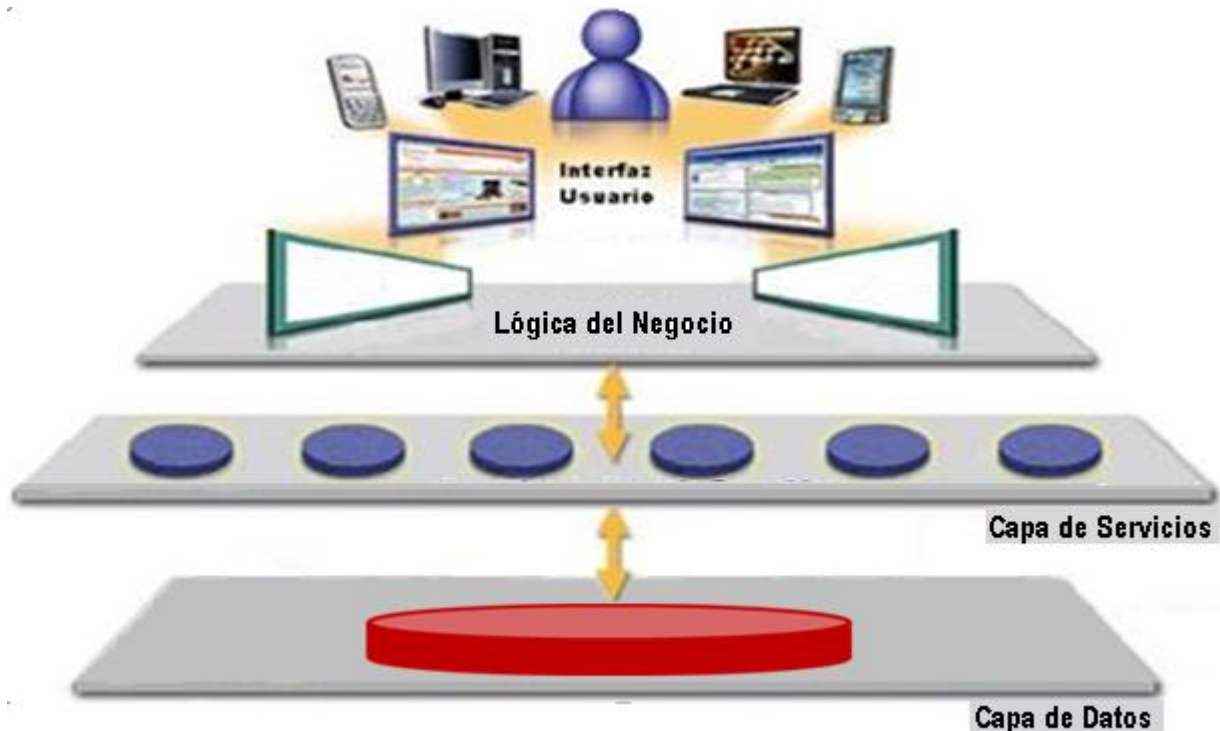
Figura 3.1 Arquitectura del Sistema.
