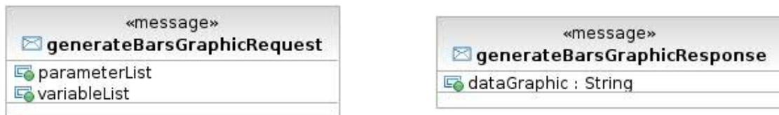
**Figura: 4.10 Diagrama de Mensajes para generateBarsGraphic.**
