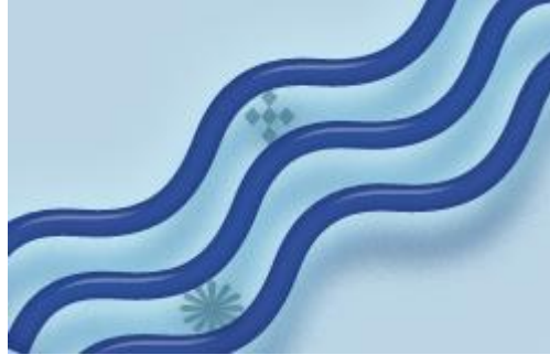
Fig. 1.3.1 El flujo de los fluidos puede ser rotatorio o no rotatorio.
