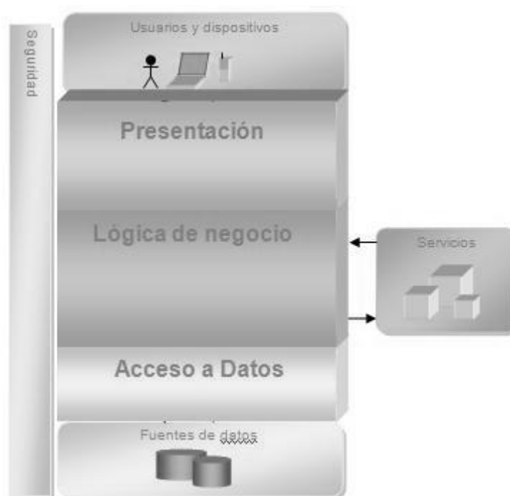
Figura 3.18 Arquitectura en 3 capas.
