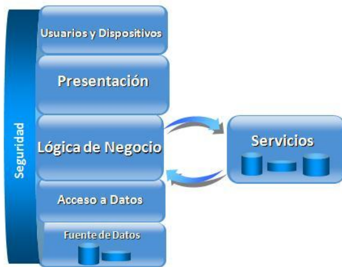
Figura 3.17 Arquitectura en 3 capas.
