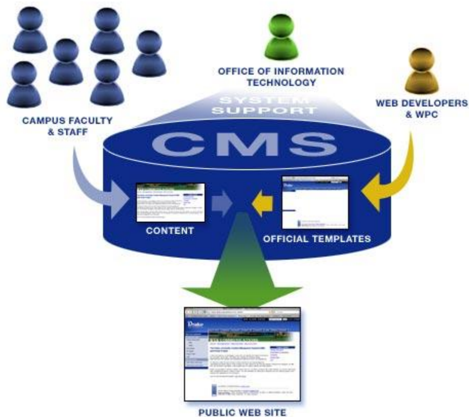
Figura 1. Funcionamiento de un CMS
