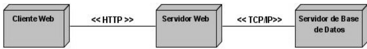
Figura 1.22 Diagrama de despliegue
