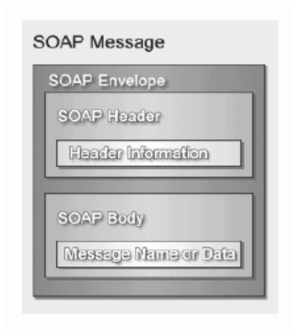
Figura 1.3 Estructura de un mensaje SOAP.
