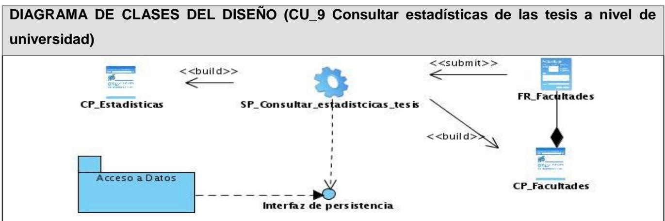
Figura 28. Diagrama de clases del diseño (CU\_9 Consultar estadísticas de las tesis a nivel de universidad)
