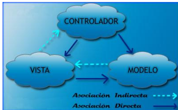
Figura 2.4: Patrón de Arquitectura Modelo Vista Controlador
