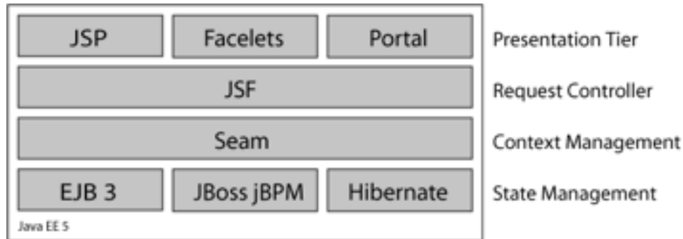
Fig.1-6 Estructura de Seam
