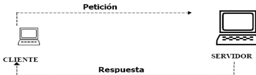
Figura 2: Intercambio de información entre el cliente y el servidor.
