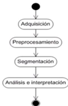
Figura 1.5. Etapas de un sistema de Visión artificial.
