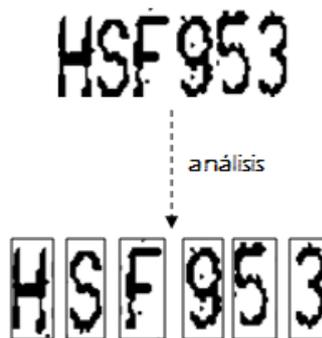
Figura 3.1. Misión del módulo "Extracción de los caracteres de la matrícula".
