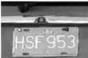
Figura 2.5. Región seleccionada como posible matrícula alineada respecto a la horizontal. (corregida la inclinación de  $-2^\circ$ )
