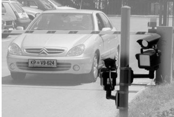
Figura 4.1. Control de acceso utilizando un sistema basado en ANPR.
