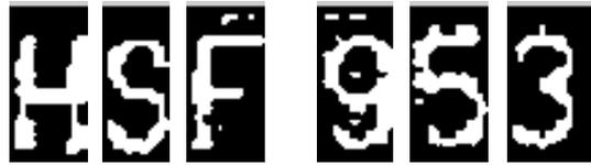
Figura 3.6. Regiones recortadas mediante el análisis de la proyección horizontal.
