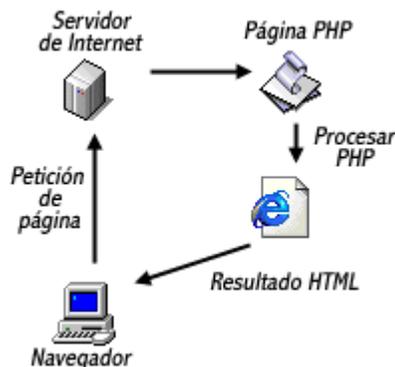
**Fig. 1.7.2.1.1 Funcionamiento del PHP**
