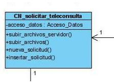
Figura 6. Capa de lógica de aplicaciones del diagrama de clases del diseño del CU: Solicitar teleconsulta.
