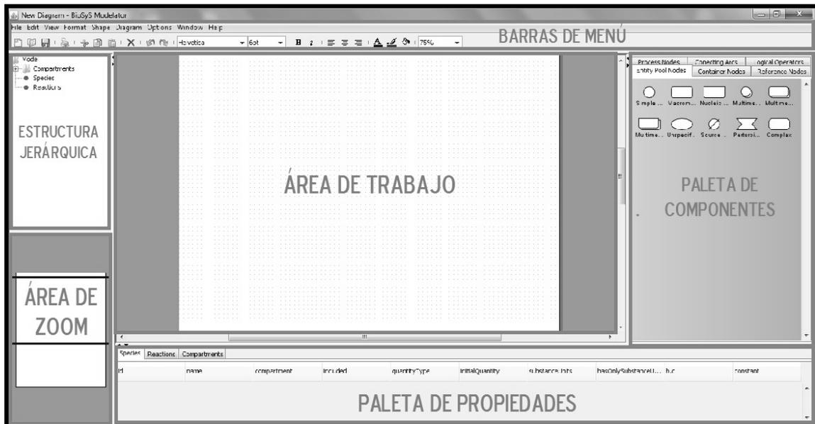
Figura 16. Principales áreas de la interfaz del Modelador Gráfico para alasBioSys.
