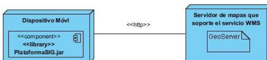
**Figura 12:** Diagrama de despliegue.
