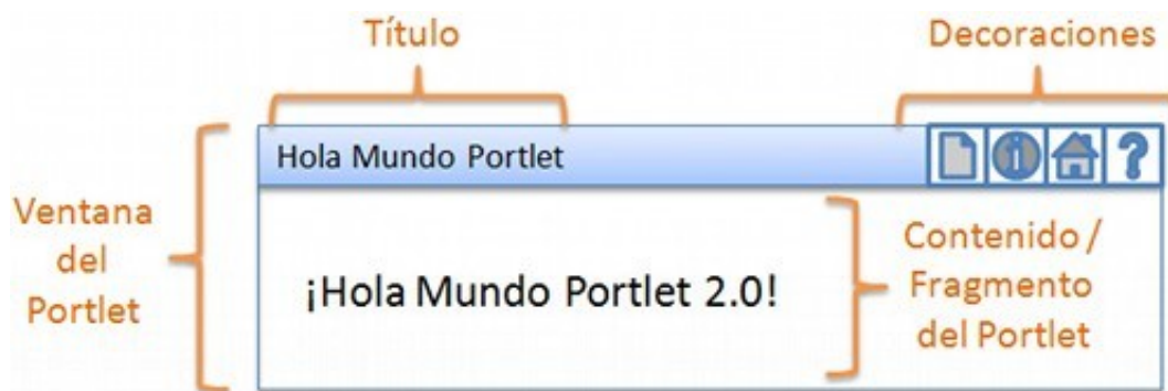
Figura 4: Anatomía de un portlet. Estos componentes permiten personalizar la forma en que se muestran, las decoraciones a menudo son opciones de navegación (ayuda, edición o vista) o estados (minimizado, maximizado o normal). El contenido de un portlet es también una página web ya que produce código HTML.
