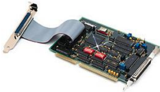
Fig. 5 Tarjeta de adquisición de 12 bit con 8 entradas análogas, 2 salidas análogas y 24 E/S digitales.
