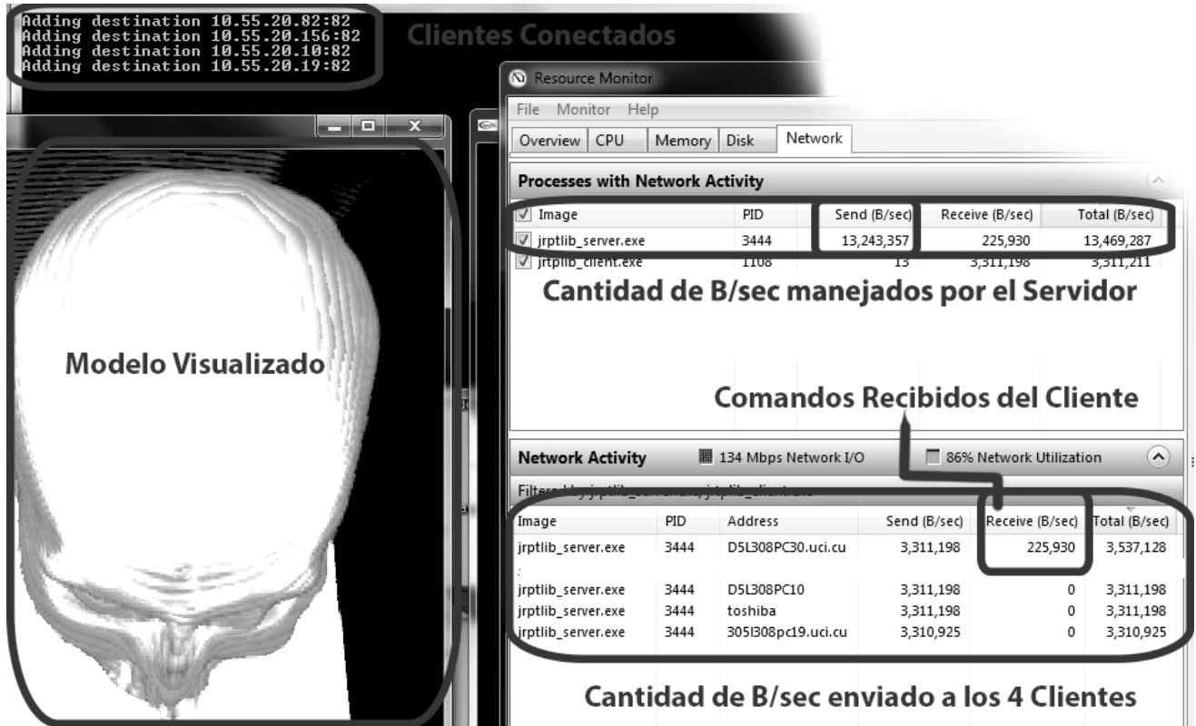
Figura 23: Tráfico de la red en el sistema cliente-servidor.
