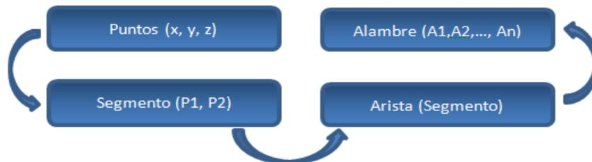
Fig. 15 Jerarquía proporcionada por Open CASCADE útil en la creación de los perfiles.
