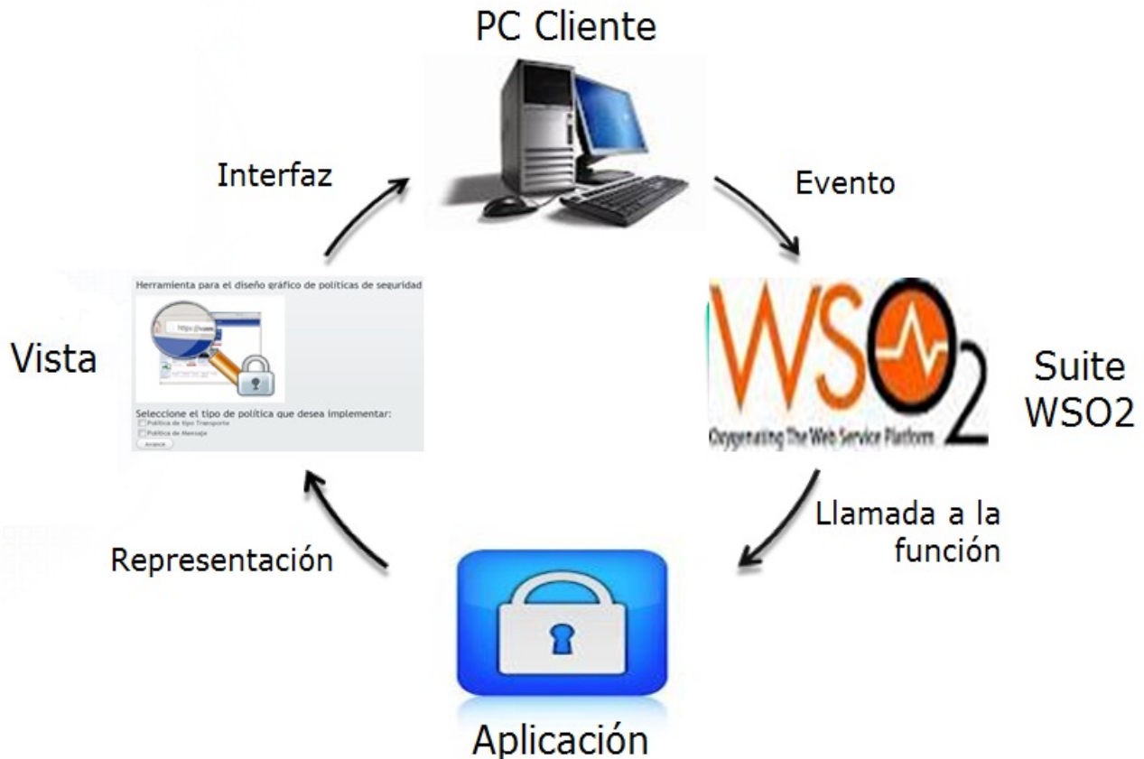
Figura 3.1 Representación del flujo de eventos dentro del patrón de arquitectura MVC
