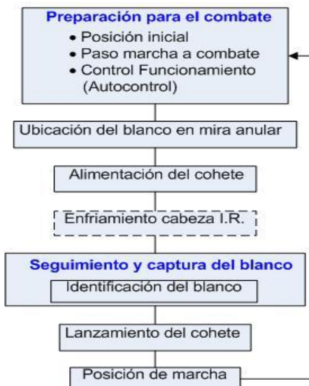
Fig. 1.1 Algoritmo general simplificado de trabajo combativo del complejo coheteril C-10
