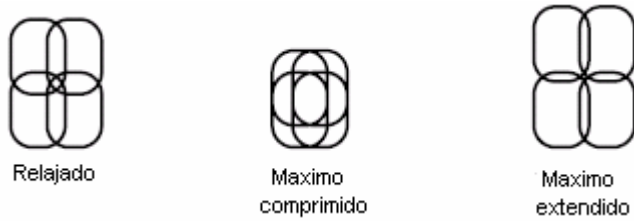
Fig. 6 Grados de libertad de un eslabón en 3D ChainMail
