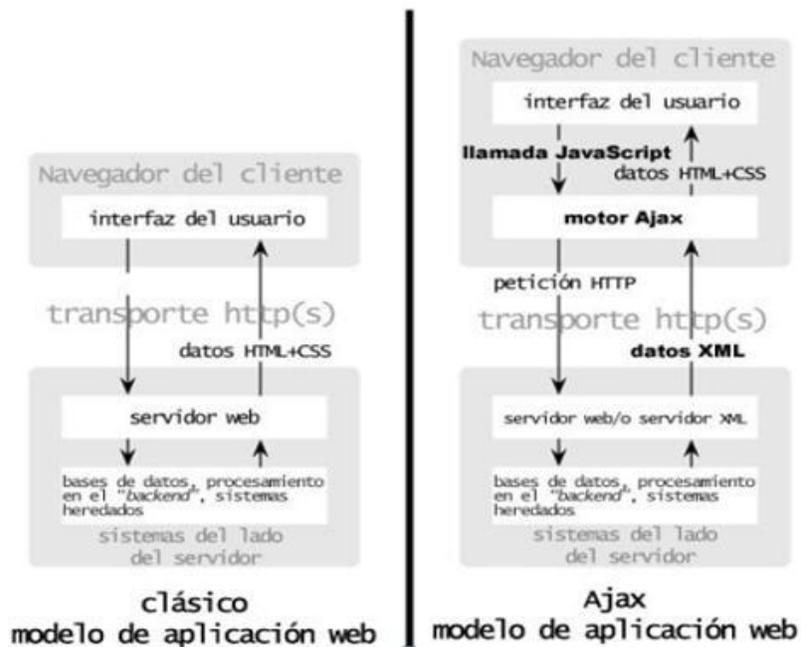
**Imagen 2.** Comparación gráfica del modelo tradicional de aplicación web y del nuevo modelo propuesto por AJAX.
