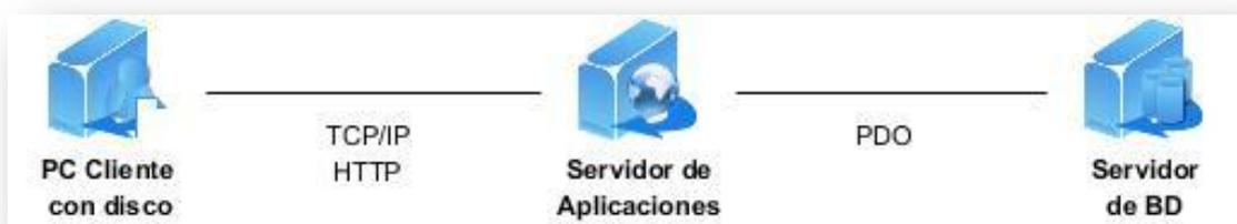
Figura 3.1 Diagrama de despliegue de escenario para PC cliente con disco
