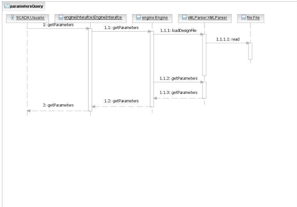
Fig. 25 Diagrama de secuencia que representa la solicitud de parámetros desde el SCADA.
