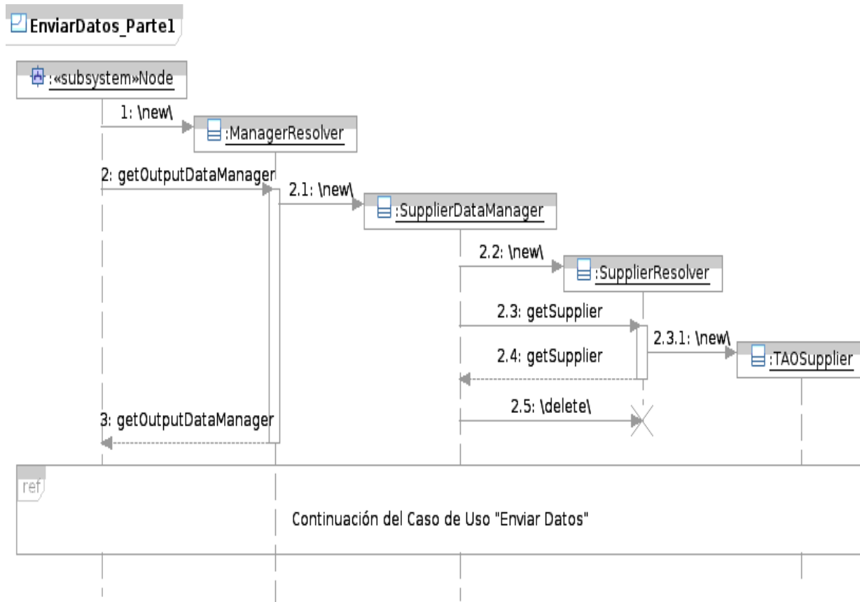
Figura 28 Primera parte del diagrama de secuencia del caso de uso Enviar Datos.
