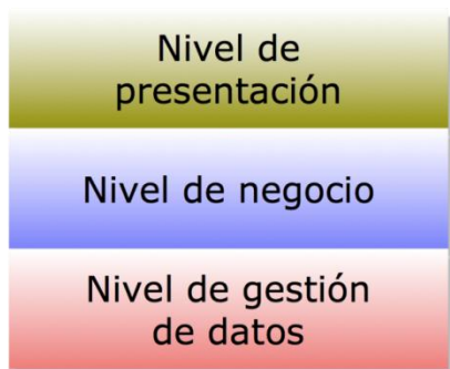
Figura 2: Patrón de arquitectura Multicapas
