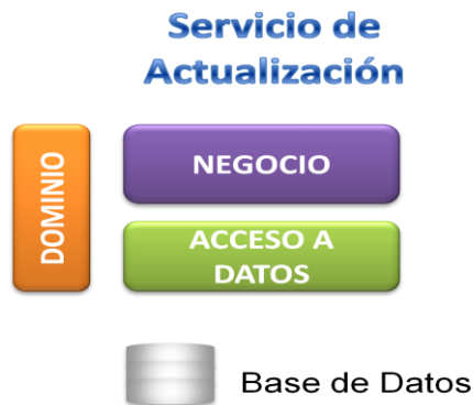
Figura 2.10 - Arquitectura del Módulo Servicio de Actualización.
