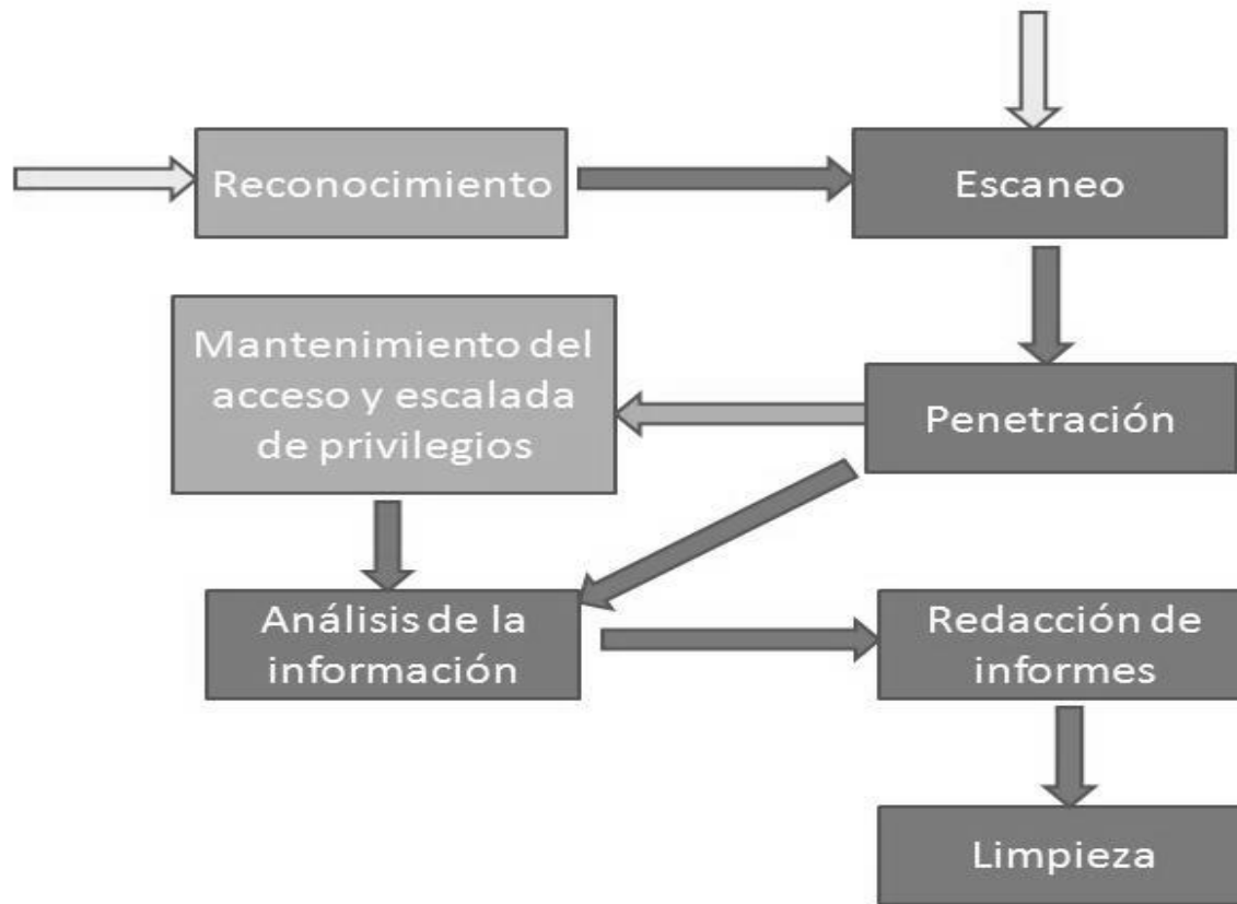
Figura 2.3 Fases de un PenTest
