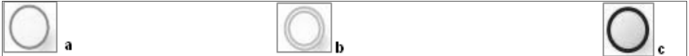
Fig. 4: Componentes que representan eventos a) Eventos de Inicio b) Eventos Intermedios c) Eventos de Fin
