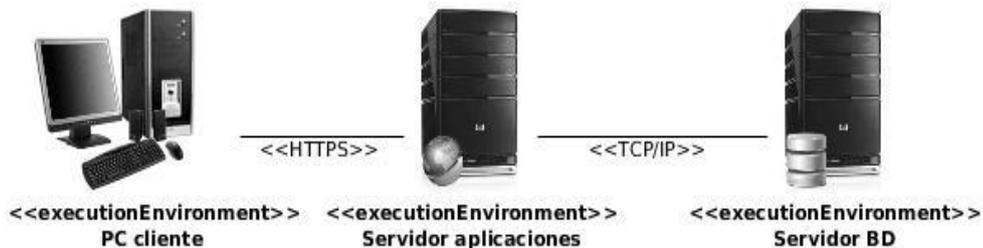
Figura 6. Diagrama de distribución física del módulo de reportes.
