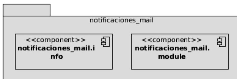
Figura 7: Diagrama de componentes del paquete notificaciones\_mail.
