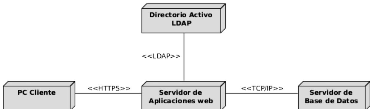
Figura 9: Diagrama de despliegue del Sistema de gestión de productos y servicios.
