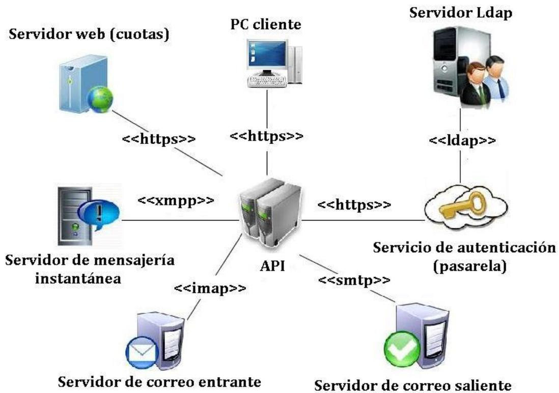
Figura 4. Diagrama de despliegue.
