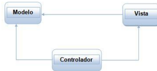
Figura 4: Estilo arquitectónico Modelo-Vista-Controlador.
