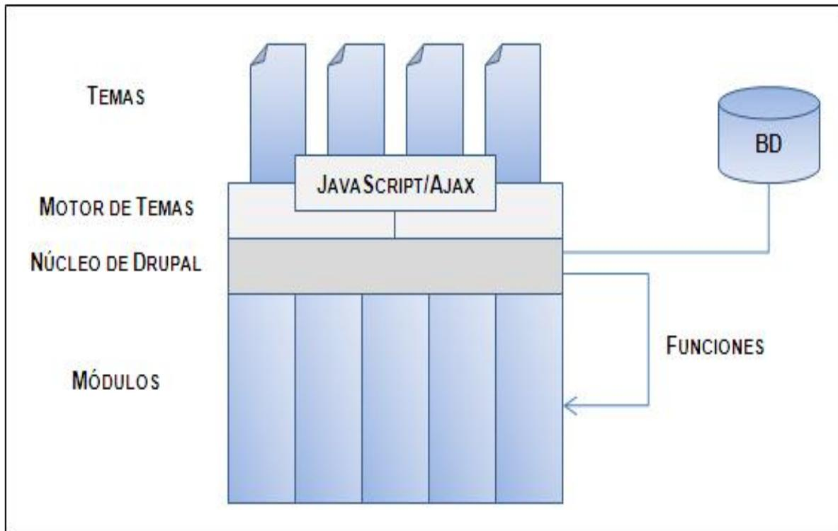
En la figura anterior se muestra como es la estructura en capas del CMS Drupal donde las vista está formada por los por los Temas, Motor de Temas y Java Script/Ajax; el modelo lo conforma la base de datos y el controlador está formado por el Núcleo de Drupal y los Módulos. Las Funciones están para facilitar la comunicación entre el Núcleo de Drupal y los Módulos.
