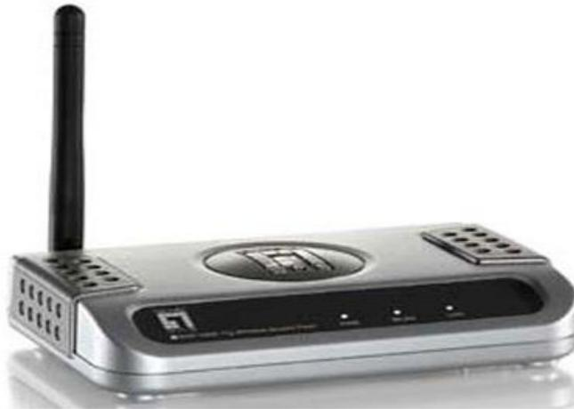
**Figura 1.13 Repetidor**
