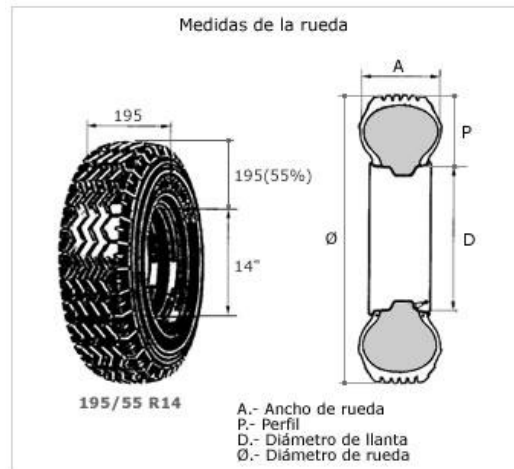
Figura 7: Cálculo del diámetro de los neumáticos.
