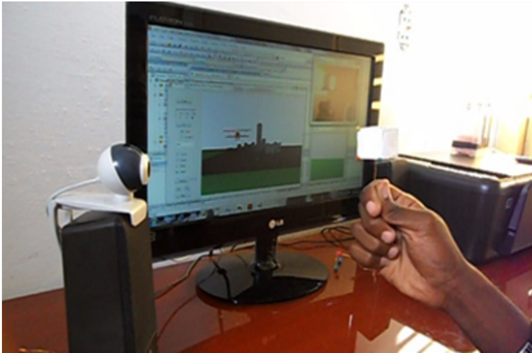
Figura 22: Usuario de una aplicación de RM. La cámara capta los movimientos del objeto que sostiene el usuario. El avión dibujado en la escena virtual se mueve según los movimientos del objeto.
