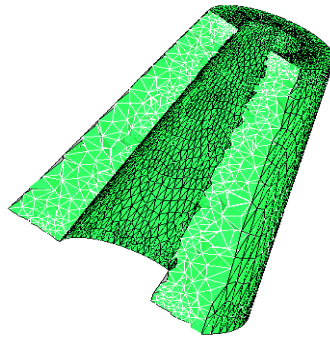
FIG 2: Representación de una malla volumétrica.
