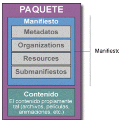
Figura 1: Estructura de un paquete IMS Content Packaging.
