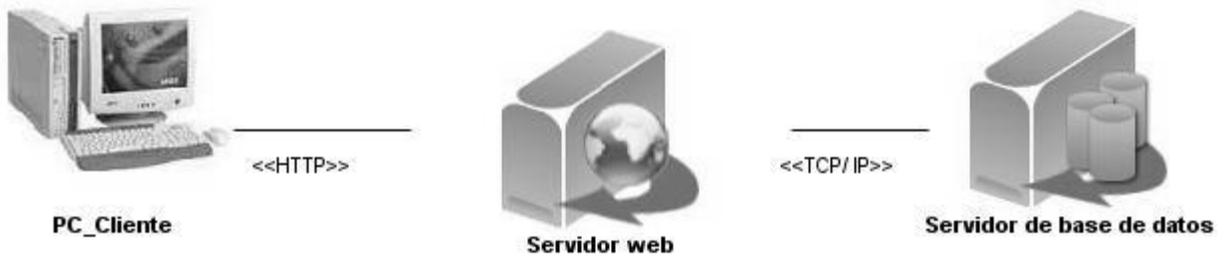
Figura 11: Diagrama de despliegue
