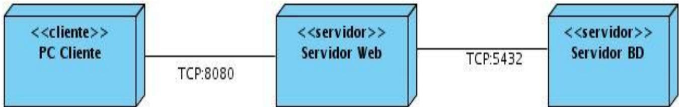
Figura 17 Diagrama de Despliegue.
