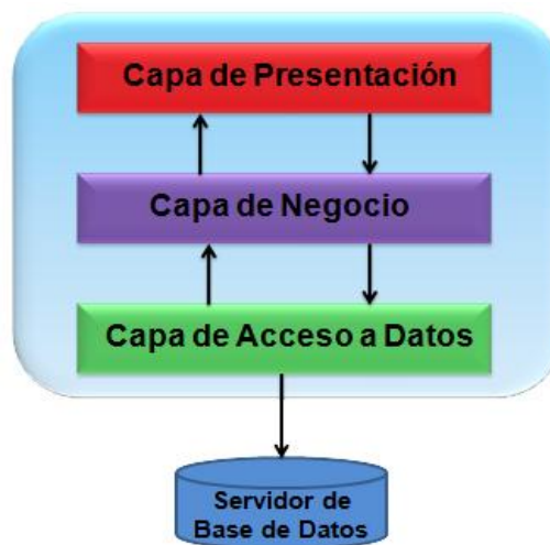
Figura 7. Arquitectura en capas. (35)
