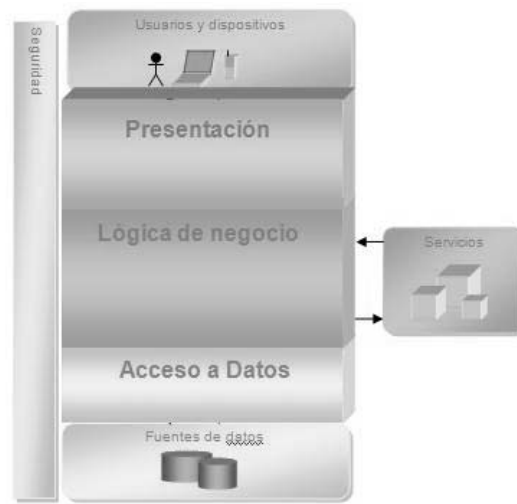
Figura 3.12 Arquitectura en 3 capas.
