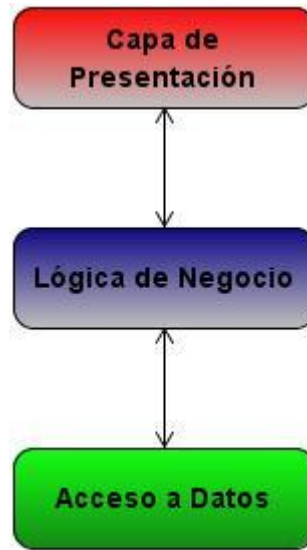
Figura 2 Arquitectura en 3 Capas
