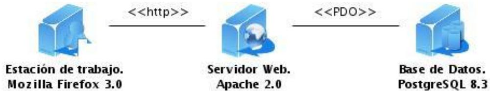
Figura 14: Diagrama de despliegue.
