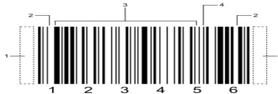
Figura 2 Estructura de una tarjeta con código de barra
